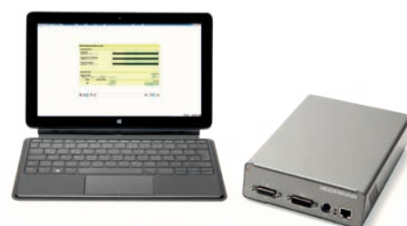
Appareil de contrôle PWM 21 avec le logiciel de réglage et de contrôle ATS inclus dans la livraison
