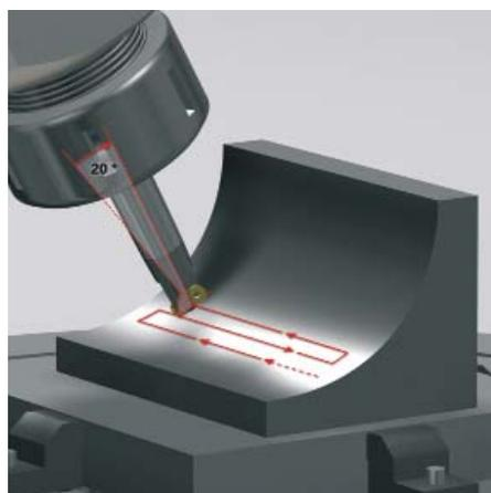
Usinage avec un angle d'inclinaison
