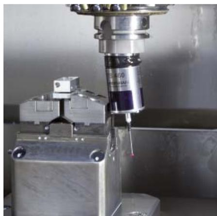
TS 460 avec protection anti-collision
