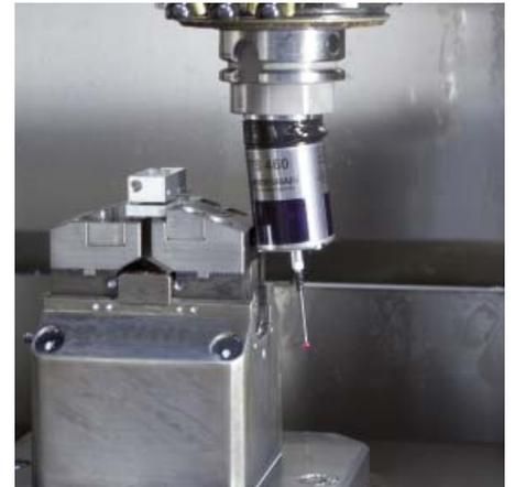
TS 460 avec protection anti-collision
