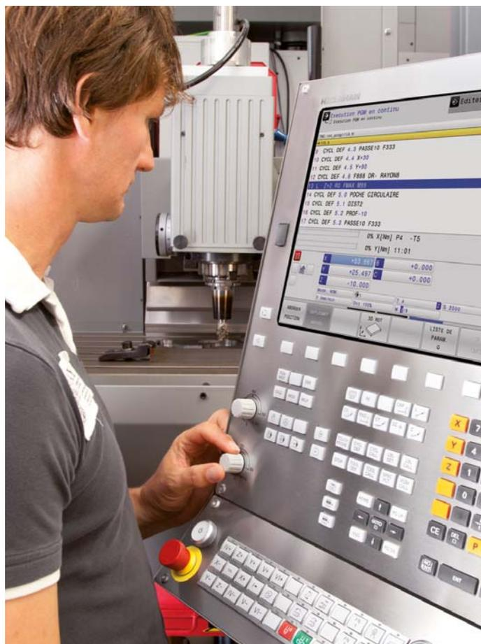
**La TNC 620 est compacte et structurée de manière claire.** Il s'agit d'une commande de contourage compacte et polyvalente, capable de piloter jusqu'à cinq axes, avec une broche asservie. Grâce à son concept flexible de commande – programmation en Texte clair HEIDENHAIN au pied de la machine ou à distance – et à ses performances, elle est utilisable sur des fraiseuses et perceuses universelles pour :
