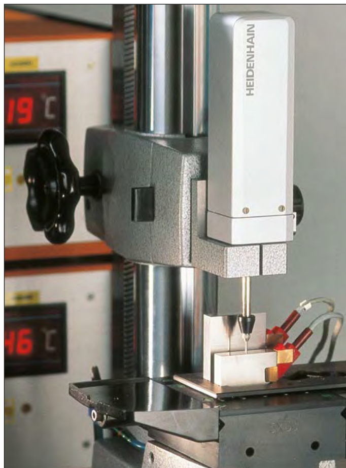
Etalonnage de cales-étalons
