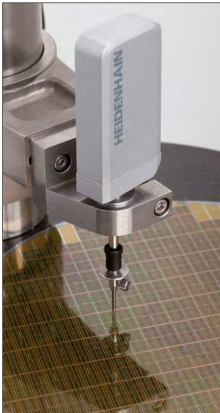
Mesure de l'épaisseur de wafers en silicium
