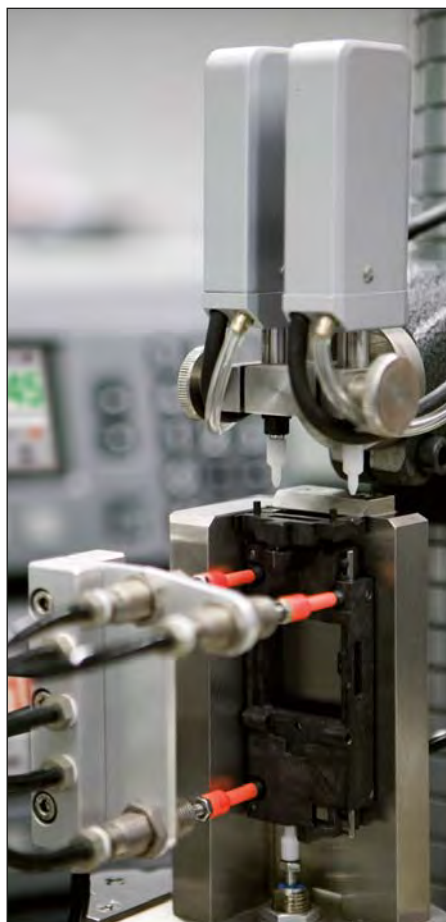
Acquisition de positions sur une table X/Y pour le montage de lentilles
